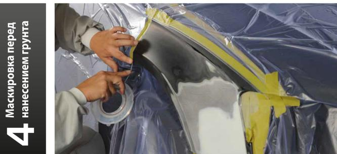
► Для достижения наилучших результатов поверх маскирующей ленты 3M нанесите ленту для плавного перехода 3M™, чтобы обеспечить плавный переход границ грунта.
