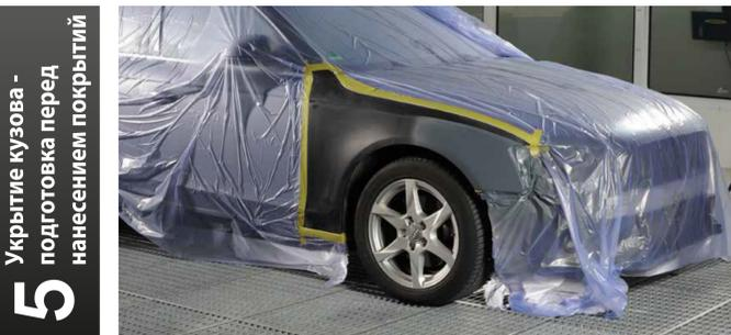
► Перед нанесением слоев базового покрытия и лака обрежьте дополнительную маскирующую пленку и закрепите ее по контуру и внутри проемов.
