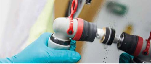
► Éliminez les grains de poussières avec le disque à support film 3M™ Finesse-it™ Trizact™, 32 mm grain 3000 monté sur l'outil prévu à cet effet.
