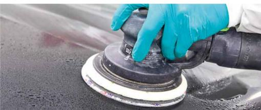
► Affinez les rayures avec le disque de finition fin 3M™ Trizact™ 443SA, grain 3000, 150 mm monté sur une ponceuse orbitale.
