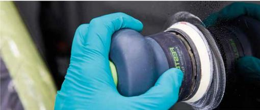
► Affinez les rayures avec le disque de finition fin 3M™ Trizact™ 443SA, grain 8000, 75 mm monté sur une ponceuse orbitale.
