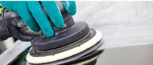
► Poncez la zone à l'aide d'un disque abrasif de finition Purple 3M™ Hookit™ 260L, grain P1500 - P2000.
