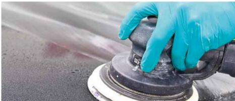
► Lixe a área com um Disco de Acabamento Fino 3M™ Trizact™ 443SA, grão 3000, 150 mm numa lixadora orbital.
