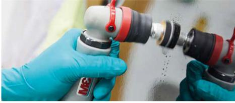
► Remover defeitos com o disco de filme 3M™ Finesse-it™ Trizact™, 32 mm grão 3000 na ferramenta de remoção de defeitos.
