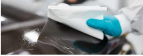
► Entfetten Sie die Oberfläche unter Anwendung von Produkten des Lackherstellers oder anderen empfohlenen Produkten. Grundsätzlich sind die Anweisungen des Herstellers zu beachten.
