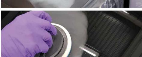
► 3M™ Hookit™ Flexible Schaumstoffscheibe P800-P1000 großflächiges Schleifen des Originallacks.
