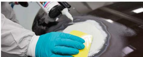
► Tragen Sie die Spachtelmasse auf den beschädigten Bereich auf, wobei Sie die umliegende lackierte Fläche möglichst vermeiden sollten.
