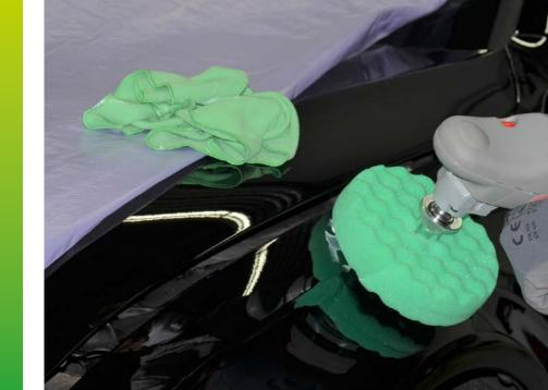
► Geben Sie eine kleine Menge 3M™ Perfect-It™ Schleifpaste Plus Extreme auf ein grünes Schaumstoff-Pad, das auf einem Rotationspolierer montiert ist.
