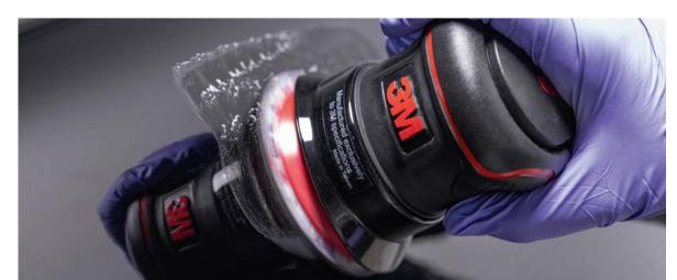
► Nachbearbeitung von Kratzern mit einer 3M<sup>™</sup> Trizact<sup>™</sup> Feinschleifscheibe 443SA, Körnung 5000, 75 mm auf einem Schwingschleifer.
