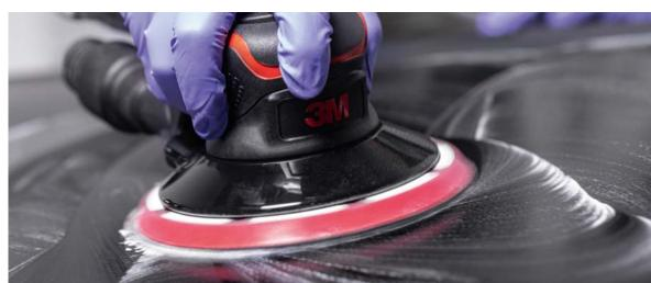
► Schleifen Sie die Fläche mit einer 3M™ Trizact™ Feinschleifscheibe
