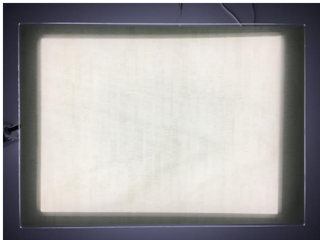
写真3 製造時に起因するムラが目立つ例 (DG-1678)
