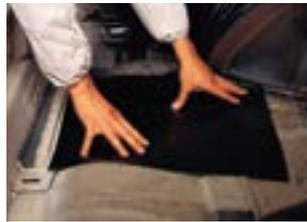
Las láminas amortiguadoras de sonido 3M™ se pueden aplicar al suelo de los vehículos, los compartimentos del motor, los compartimentos de la rueda de repuesto, tapas protectoras, maleteros, la parte interior de las puertas y los paneles de la carrocería.
