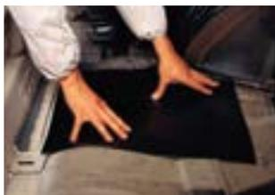
Les tampons insonorisant 3M™ peuvent être appliqués sur les planchers, dans les compartiments moteurs, les compartiments de roue de secours, les fonds de coffre, sous le capot moteur, à l'intérieur des portières ou sur les ailes.
