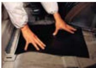
I pannelli insonorizzanti 3M™ possono essere applicati sui pianali, nel vano motore, nello scomparto della ruota di scorta, nei bauli, nei bagagliai, all'interno delle portiere e sui pannelli della carrozzeria.
