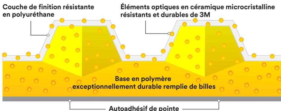
*Une coupe transversale d'un Ruban de marquage pour chaussées Stamark<sup>MC</sup> 3M<sup>MC</sup> de Série 380 illustre les technologies de pointe de 3M dans tous les aspects de la conception.*
