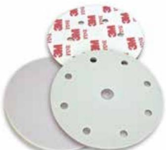
Гибкие шлифовальные круги 3M™ Hookit™ SoftBack на полиуретановой основе предназначены для финишной обработки грунтованных поверхностей. С ручным держателем 3M™ 05791 могут использоваться как губка. Круги 3M™ Hookit™ SoftBack подходят как для сухой, так и для влажной шлифовки.
