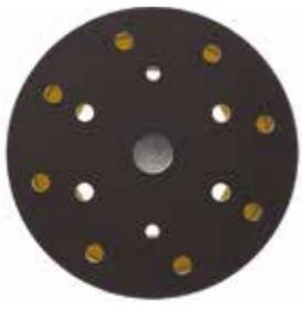
Мягкие приставки 3M™ Hookit™ из вспененного полиуретана используются с кругами 3M™ Hookit™ на бумажной или пленочной основе, чтобы обеспечить более бережную обработку изогнутых деталей, выгнутых и вогнутых поверхностей, закругленных кромок. Мягкие приставки 3M™ Hookit™ позволяют сохранить геометрию деталей даже при работе абразивом грубой зернистости.
