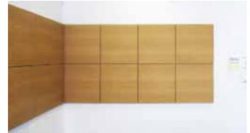
残響室法吸音率(「アルミフレーム工法」で測定)
