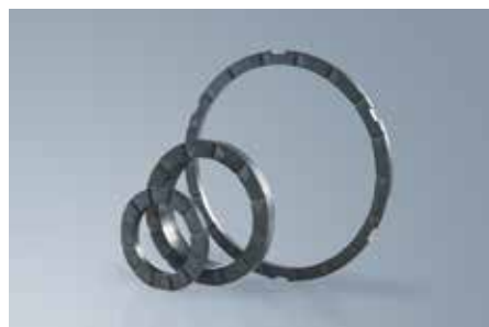
Laserstrukturierte Gleitringdichtungen aus 3M™ Siliciumcarbid (links: Radiallager, rechts: Axiallager) werden z. B. in hochbeanspruchten Chemiepumpen, in Magnetkupplungen für hermetisch dichte Pumpen sowie in Rührwerken für chemische und pharmazeutische Verfahren verwendet.
