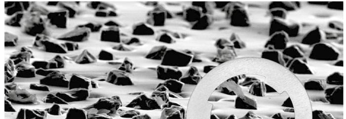
3M™ Reibwerterhöhende Scheiben und REM-Aufnahme der Nickel-Diamant-Beschichtung
