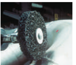
溶接箇所のクリーニング
