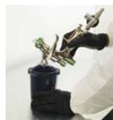
**5** Après la pulvérisation, déconnectez l'air comprimé, retournez le pistolet et appuyez sur la gâchette pour que la peinture retourne dans le godet. Désengagez le pistolet du système 3M™ PPS™ 2.0.
