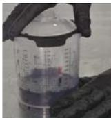
**3** Placez le couvercle sur le haut de la poche, positionnez le couvercle sur le haut du godet et verrouillez en vissant par 1/4 de tour. Tournez pour verrouiller.
