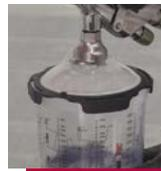
**4** Sélectionnez le bon adaptateur pour votre pistolet de pulvérisation. Poussez vers le bas et tournez jusqu'à ce que l'adaptateur vienne se verrouiller dans le couvercle. (Rendez-vous sur : [www.3M.fr/repaauto](http://www.3M.fr/repaauto) pour trouver l'adaptateur correspondant à votre pistolet de pulvérisation.)
