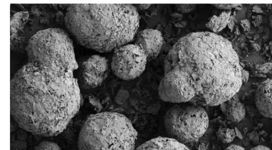
20 µm Ansicht im Rasterelektronenmikroskop: CFA 250S
