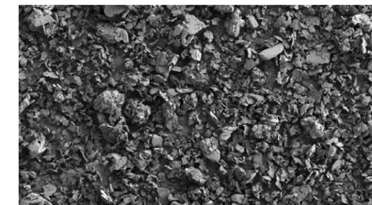
20 µm Ansicht im Rasterelektronenmikroskop: CFA 50M
