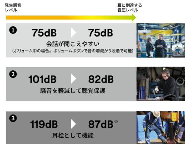
※3M™ ウルトラフィット™ 騒音制御型耳栓用プラグ使用時の遮音値：SNR=32dB
