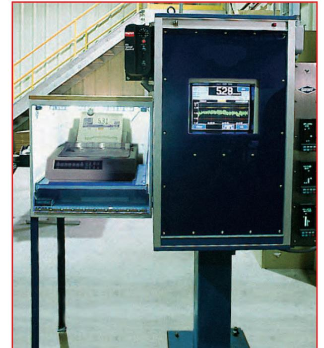
► 高分辨率  $\gamma$  射线测量仪，根据光子的后向散射规律，能够实时监测腹板厚或定量，并提供可追溯的记录。
