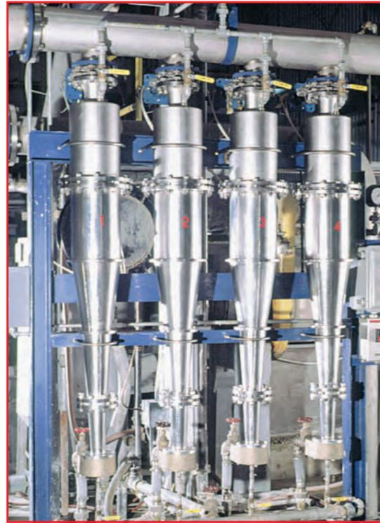
◀ 四缸造纸机上的离心清洗设备
