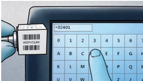
5. Der Skalierungsfaktor – aufgedruckt auf dem Block – muss vor dem Fräsvorgang in die Software eingegeben werden.
