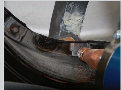
Possibilité de souder par point à travers la colle ou riveter dans les 30 min qui suivent l'application.
