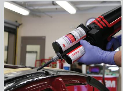
Peut être utilisée pour coller les panneaux de porte, les ailes, les panneaux de toit/pavillons, les panneaux latéraux des caisses de camions, les panneaux latéraux des camionnettes et des utilitaires et les bas de caisse, sur recommandation des constructeurs automobiles.
