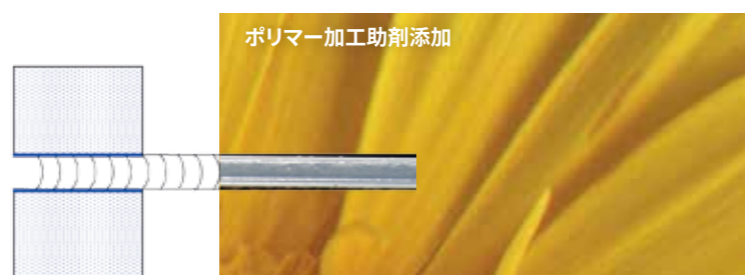
ポリマー加工助剤添加 ポリマー加工助剤を使用することにより、金属表面がコーティングされたような状態となります。金属表面の熔融樹脂が滑らかに流れることで、中央部と金属表面の速度差が小さくなり、メルトフラクチャーが低減します。
