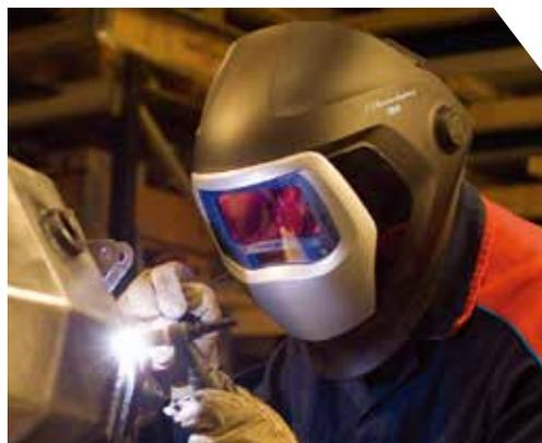
滤光镜优异光学性能提供持续观察的舒适度。可用于1安培的TIG焊
