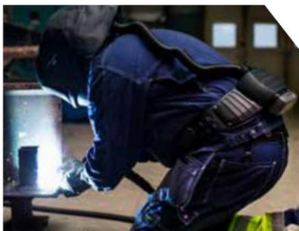
L: 柔软的脸部密封衬: 在焊接面罩内形成正压的环境, 防止外部污染物进入面罩内部
