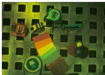
普通自动变光焊接滤光镜在亮态遮光号下的视觉效果
