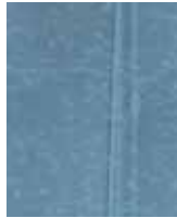
日射調整フィルムの金属膜劣化
