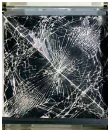
層間変位破壊実験【JIS A 5759 に準じる】▶
