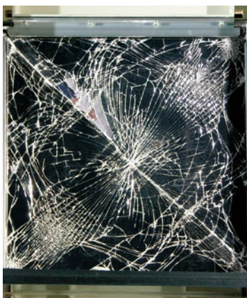
層間変位破壊試験 (JIS A 5759:2016 に準じる)▶
