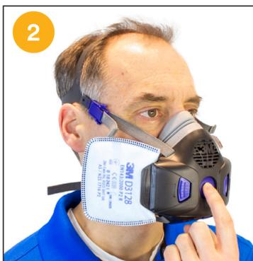
2. Pulse suavemente el botón de comprobación del ajuste hasta que sienta cierta presión. Mantenga el botón en esta posición y aspire tranquilamente. Si siente que la pieza facial se comprime ligeramente creando vacío en la cara y no detecta fugas de aire entre la cara y la pieza facial, el ajuste es adecuado.
