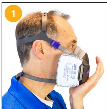
1. Bloquee la abertura de la tapa de válvula de exhalación con la mano y exhale suavemente. Si la media máscara se hincha ligeramente y no detecta fugas de aire entre la cara y la pieza facial, el ajuste es adecuado.
