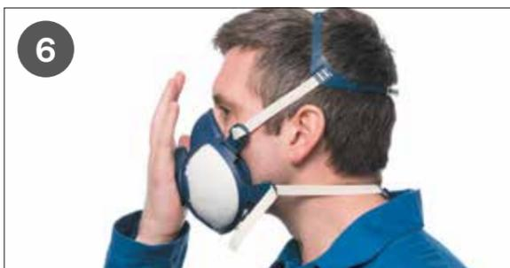
**Étape 6 :** effectuez un contrôle de l'étanchéité par pression positive et/ou négative à chaque mise en place du masque.
