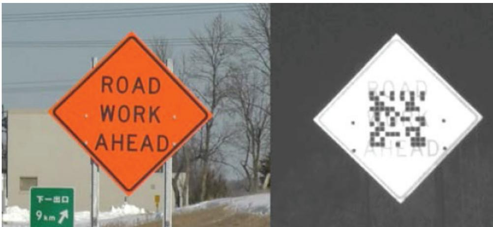
Des codes 2D infrarouges intégrés dans un panneau de signalisation pouvant être lu à la fois par l'œil humain et par la vision artificielle.
