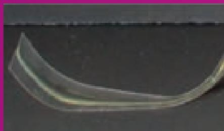
Eine dünne Schicht klassische Monomere enthaltendes Komposit nach der Lichthärtung. Die Volumenschrumpfung führt dazu, dass sich das Material verformt.
