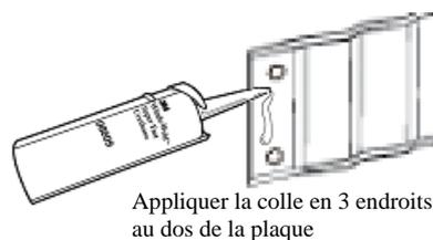
Vous pouvez trouver la colle uréthane 3M chez la plupart des revendeurs. Elle est conditionnée dans une cartouche standard et doit être appliquée à une température minimale de 16 C°, en condition atmosphérique sèche. Une cartouche de colle permet de coller environ 20 plaques de SDL.
