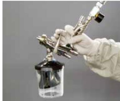
1. エアホースを差し込み、スプレーガンを逆さにしトリガーを引き、ライナー内の空気を抜きます。
