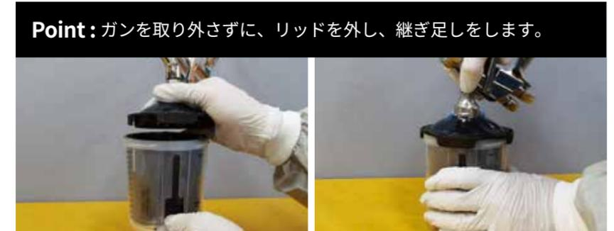
**Point:** ガンを取り外さずに、リッドを外し、継ぎ足しをします。
