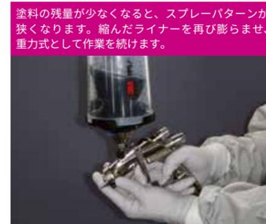
塗料の残量が少なくなると、スプレーパターンが狭くなります。縮んだライナーを再び膨らませ、重力式として作業を続けます。
