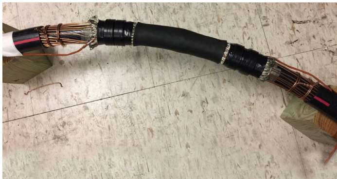
Figure 2 : Ensemble manchon de blindage avec ressorts à force constante, recouvert de ruban isolant en vinyle*
