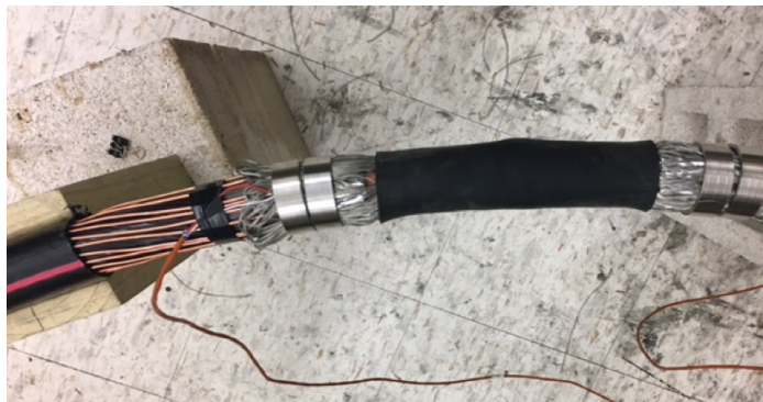
Figure 3 : Ensemble manchon de blindage avec ressorts à force constante, non recouvert de ruban isolant en vinyle*
