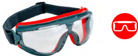
Hiervon unterscheiden sich **Vollsichtbrillen**, bei denen eine umlaufende Dichtung die Augen schützt. Durch ein verstellbares Gummiband wird die Brille am Kopf fixiert, was so auch für Dichtigkeit sorgt. Vollsichtbrillen werden zum Beispiel bei der Arbeit mit Säuren, Laugen und heißen Flüssigkeiten getragen und gewährleisten, dass dabei keine Spritzer ins Auge gelangen.
