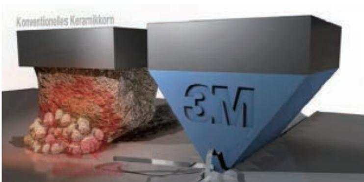
CubitronII 제품에 적용된 PSG(Precision Shaped Grain)의 강점은 작업이 계속됨에도 입자가 무너지지 않고(Dulling) 삼각형 형상의 날카로움을 유지하기 때문에 연마 가공에도 작업자가 적은 힘으로 꾸준한 퍼포먼스를 유지할 수 있습니다.
