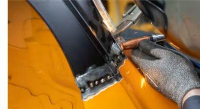
**Punktschweißnähte oder Schweißpunkte sind nicht 100% geschlossen.** Feuchtigkeit und Salz dringen von der Rückseite des Reparaturbereichs oder durch Wasserdampf in der Luft in die Schweißnähte ein. Dies kann langfristig zu Problemen durch Korrosion und Materialablösung (Delamination) führen.
