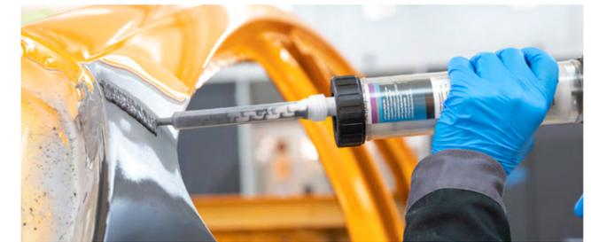
Erzielen Sie die bestmögliche Qualität auf einer Vielzahl von Substraten wie hochfestem Stahl, verzinktem Stahl und Aluminium. Das Material haftet auf sich selbst, falls Nachbesserungen oder eine weitere Schicht erforderlich sind.
