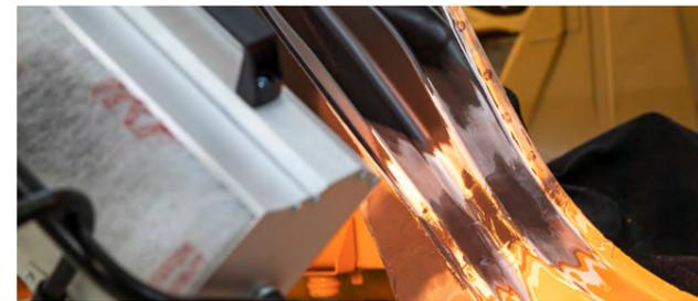
Schnell schleifbar – schleifbar nach 20 Minuten bei beschleunigter Trocknung, bei Lufttrocknung nach vier Stunden (bei 22 °C).
