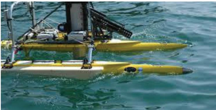
Figure 6. Liaison d'un aide à la flottaison en mousse syntactique sur de l'aluminium à l'aide d'un Adhésif époxyde 2216 Scotch-Weld<sup>MC</sup> 3M<sup>MC</sup>
