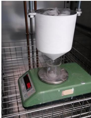
**Figura 1 - Particolare dell'apparato di misura anticondensa utilizzato**
