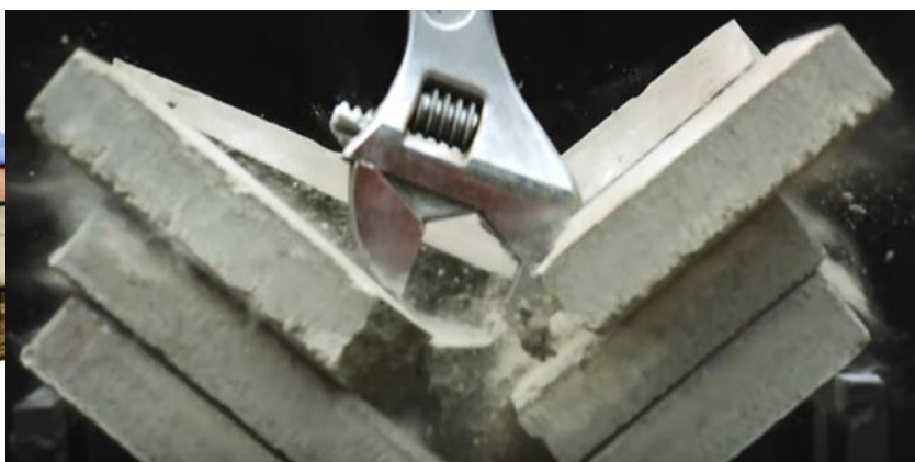
3.6kgの工具を60mの高さから落下させると 1トンを超える衝撃荷重となる*
