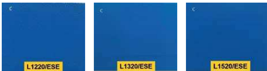
Рис. 4. Влияние жесткости монтажной ленты на качество печати плашек без микроструктурирования элементов формы на пластине ESE с технологией плоских точек (фотографии поверхности без увеличения)
