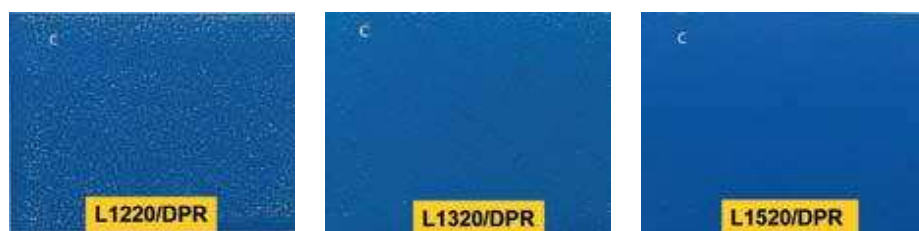
Рис. 2. Влияние жесткости монтажной ленты на качество печати плашек без микроструктурирования элементов формы на пластине DPR (фотографии поверхности без увеличения)
