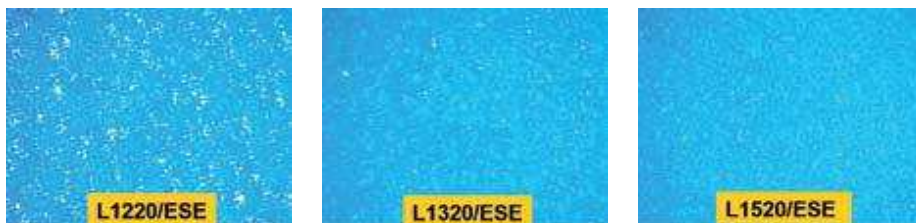
Рис. 5. Влияние жесткости ленты на качество печати плашек без микроструктурирования, пластина ESE (микрофотографии поверхности плашек с увеличением в 200 раз)
