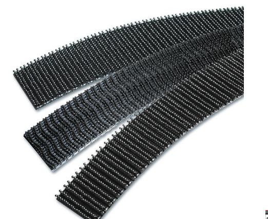
Dual Lock ist eine hervorragende Alternative zu herkömmlichen Befestigungsmöglichkeiten, wie z.B. Verschrauben, Vernieten etc. Das wiederlösbare Befestigungssystem Dual Lock besteht aus einem Polyolefinträger mit kleinen Halbkugelköpfen auf kurzen Stielen. Durch Zusammendrücken zweier Komponenten entsteht ein stabiler, belastbarer und wiederlösbarer Verschluss.
