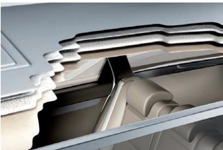
**Dachhimmel:** Das großflächig eingesetzte Absorptionsmaterial im Dachhimmelbereich reduziert das Aufheizen des Innenraums und vermindert Geräusche.
