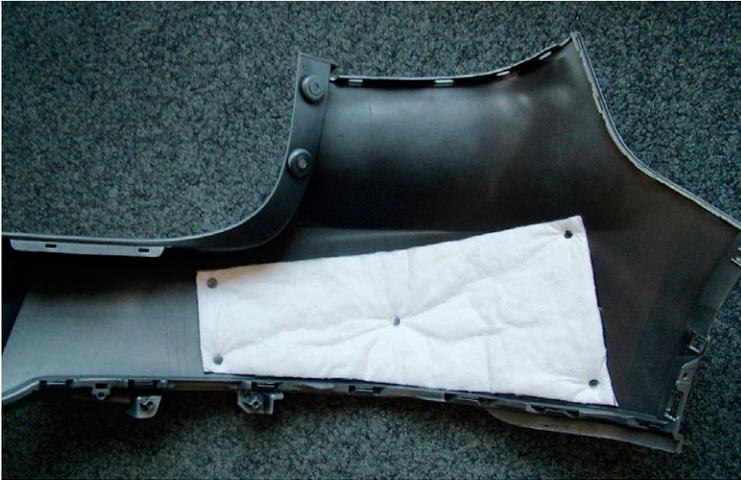
**3M™ Thinsulate™ Acoustic Insulation ist einfach in die Verarbeitungsprozesse zu integrieren.**
