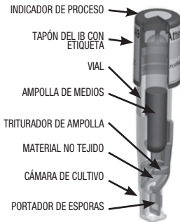
Figura 1: Diseño del indicador biológico 1492V de lectura superrápida 3M™ Attest™
