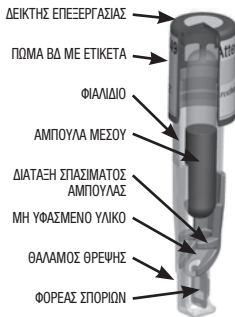
Σχήμα 1: 3M™ Attest™ Βιολογικός Δείκτης Υπερταχείας Ερμηνείας 1492V
