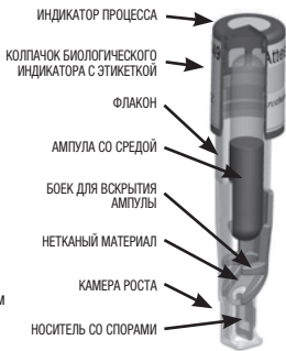
Рисунок 1. Конструкция биологического индикатора сверхбыстрого считывания 3M™ Attest™ Super Rapid Readout 1492V
