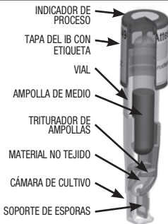
Figura 1: Diseño del Indicador biológico de lectura súper rápida 1492V 3M™ Attest™
