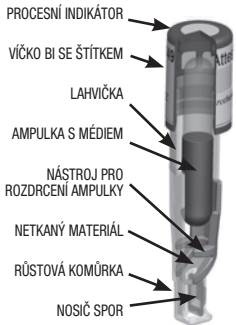
Obrázek 1: Složení biologického indikátoru s rychlým odečtem 3M™ Attest™ Super Rapid Readout Biological Indicator 1492V
