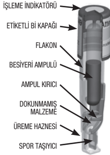
Şekil 1: 3M™ Attest™ Süper Hızlı Sonuç Veren Biyolojik İndikatör 1492V Tasarımı
