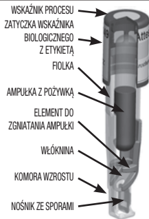
Rysunek 1: Budowa wskaźnika biologicznego o bardzo szybkim odczycie 1492V 3M™ Attest™
