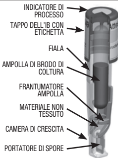
Fig. 1: Design dell'indicatore biologico 3M™ Attest™ a lettura super rapida 1492V
