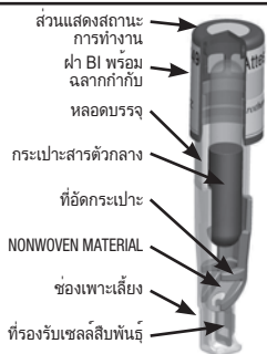
ภาพที่ 1 รูปแบบของ 3M™ Attest™ Super Rapid Readout Biological Indicator 1492V
