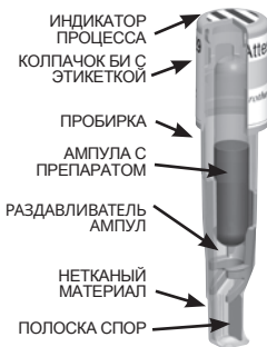
Рисунок 1. Конструкция биологического индикатора быстрого считывания 3М™ Attest™ 1295
