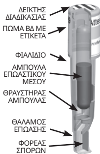
Εικόνα 1: Σχεδιασμός του 3M™ Attest™ Βιολογικού Δείκτη Ταχείας Ερμηνείας 1295
