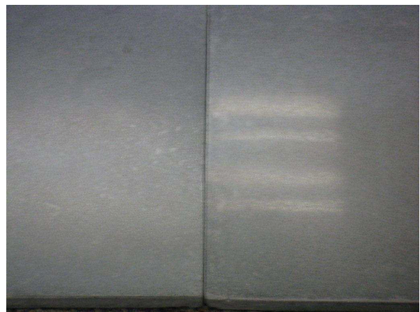
La photo ci-dessus démontre deux carreaux de béton sans revêtement avec une brillance semblable à 60 ° (42 à gauche et 49 à droite), mais dont la netteté de l'image diffère (27 à gauche et 75 à droite). Voyez de quelle façon la lumière réfléchie est nette sur le carreau de droite et floue sur le carreau de gauche.
