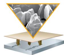
Обычное абразивное зерно имеет неправильную форму. Такое зерно «вспахивает» обрабатываемый металл, перегревая его, что снижает скорость обработки и сокращает срок службы абразивного круга.
