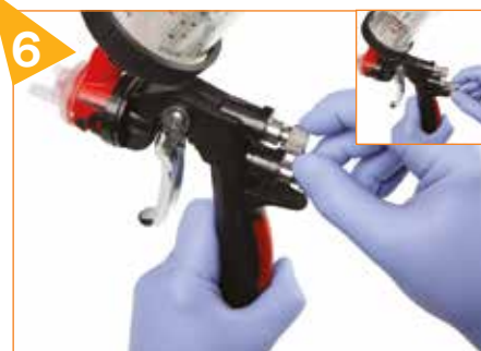
6 Régler la forme du jet et le débit du liquide afin d'obtenir un jet en éventail de la taille et du débit désirés.
