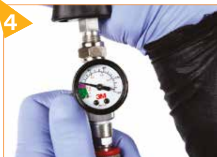
4 Régler la pression d'air à 1,7 bars en statique (air uniquement)
