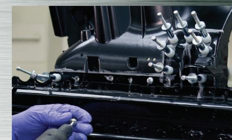
Può essere rivettato o saldato immediatamente dopo l'applicazione
