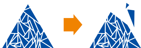
研磨時に砥粒が微細に破碎しながら常に新しいエッジを生成
