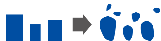
砥粒のエッジが取れ消耗する
