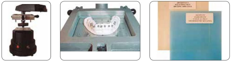
Fig. 6.- Máquina de termoformado con modelo de yeso.
