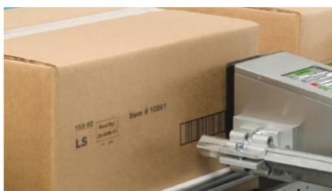
Inkjet de alta resolução para a impressão do código de barras direto na caixa de papelão com informações variáveis, data, lote de produção e validade. Através de uma interface simples é possível selecionar a impressão direto no equipamento em tempo real, agilizando o processo de identificação das embalagens de despacho.
