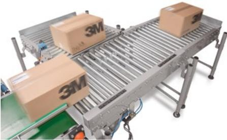
Sistema de movimentação conforme a necessidade do projeto com sistema de rejeito para eliminar as embalagens de despacho que estão fora do padrão da identificação.
