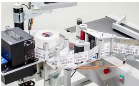
Imprime e aplica etiquetas on-line integrado ao sistema ERP com informações variáveis simples, tornando o processo de identificação das embalagens de despacho padronizado sem abrir mão da customização. Permite que o layout da etiqueta seja alterado a qualquer momento de acordo com o produto que está sendo produzido através do software 3M ou integrado ao ERP.
