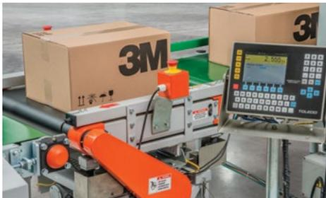
Sistema de pesagem dinâmica que permite que as caixas sejam pesadas em movimento. Utilizado em linhas com peso variável para garantir o peso correto da embalagem de despacho e conferência do mesmo no processo de identificação e rastreabilidade.
